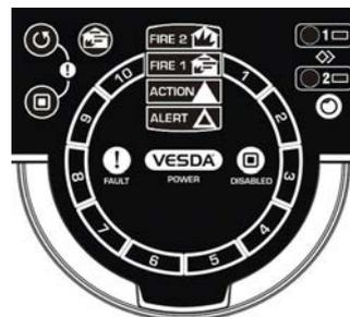
Al abrir la puerta de acceso para mantenimiento, el usuario puede activar las funciones RESTAURAR (Fuego), DESACTIVAR (Acción), Prueba de incendio (Avería), AutoLearn (Fuego) e Instant Fault Finder (Localizador Instantáneo de Averías). Cuando se activa la función Instant Fault Finder, la pantalla circular se transforma en un indicador de averías cuyos números corresponden a las averías que se enumeran a continuación.
